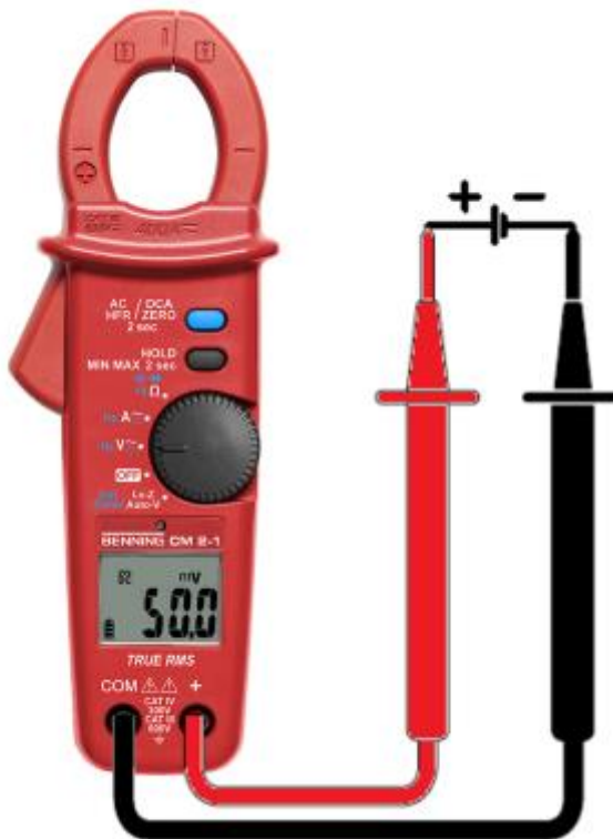
Rysunek 11: Pomiar napięcia stałego
