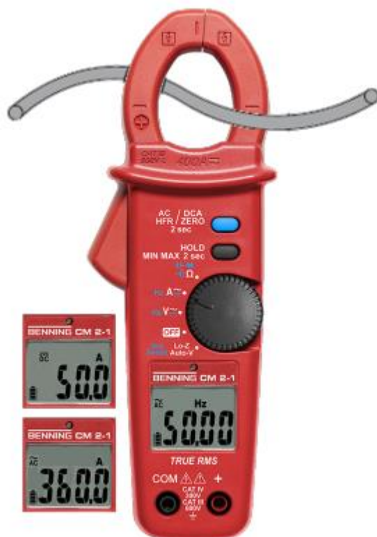
Rysunek 12: Pomiar prądu lub częstotliwości
