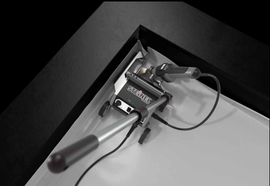
Zgrzewanie minimalnie 8 cm od brzegu dachu
